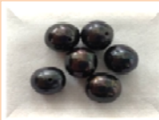
รูปที่ 2 แสดงสีของไข่มุกที่ผ่านการย้อมด้วยต่างทับทิมที่ความเข้มข้น 7% ระยะเวลา 60 วัน
